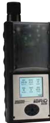
Wersja z pompką próbkującą może pobierać gaz z odległości do 30,5 metra
