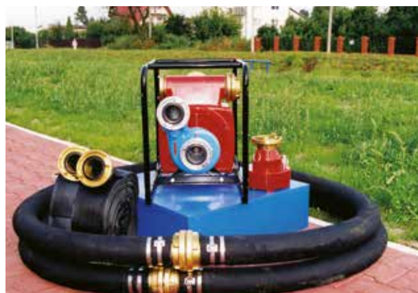
zestaw pompowy składający się z pompy TURBIMAT S III LM węży ssawnych wraz ze smokiem ssawnym i węzami tłocznymi
